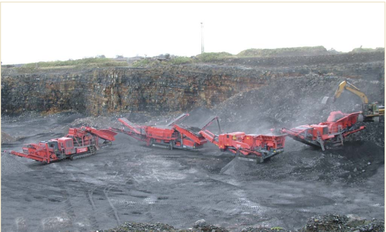
Concasseur à mâchoires J1480, percuteur I-130, crible horizontal 984 et concasseur giratoire C1540RS.
