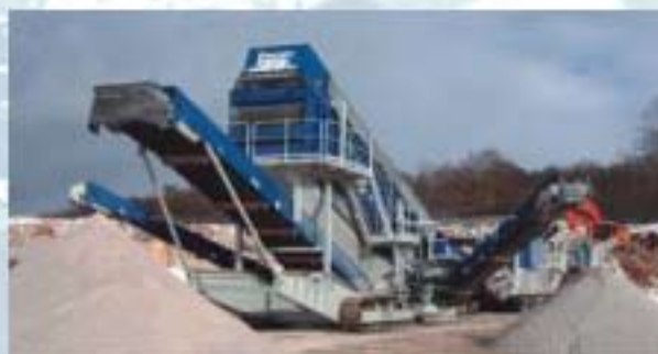
MS 20 D, crible à trois étages 12,4 m 2
