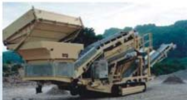
MS 15 Z, crible à deux étages 7 m 2
