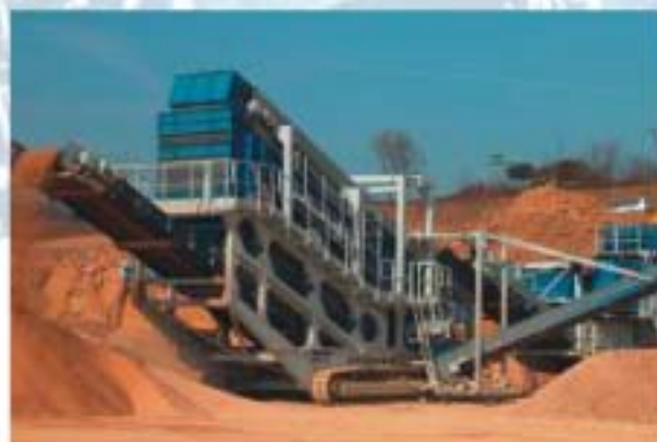
MS 23 D, crible à trois étages 18,4 m 2
